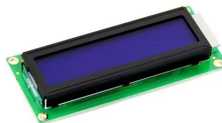
Gambar 2. Perangkat LCD ukuran 16x2
